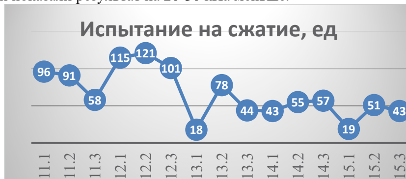
Рис. 9. График зависимости прочности на сжатие от количества цемента в составе 70%.
