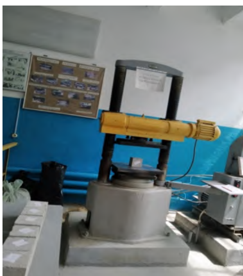
Рис. 5. Гидравлический пресс ПСУ-125
