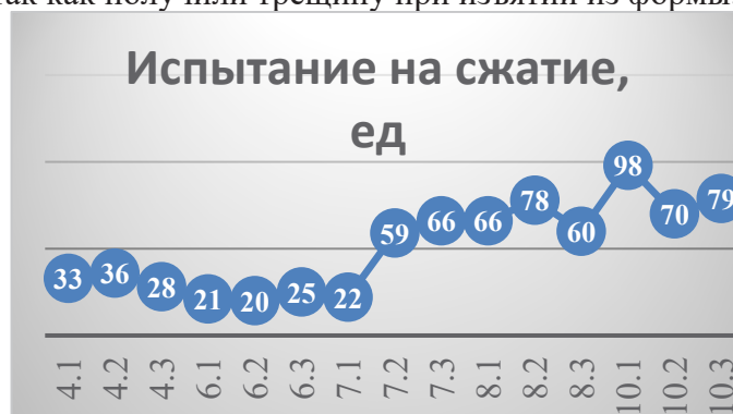
Рис. 8. График зависимости прочности на сжатие от количества цемента в составе 60%.
