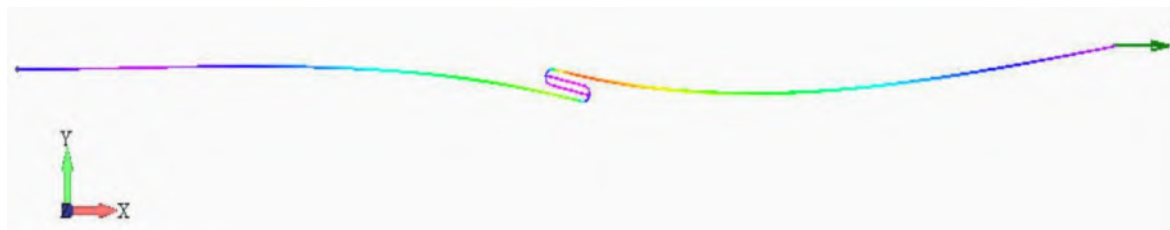
Рис.2. Распределение главных напряжений соединения стальных полос.
