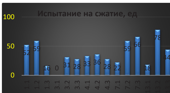
Рис. 6. График зависимости прочности ЦДП от процентного содержания жидкого стекла (20%).
