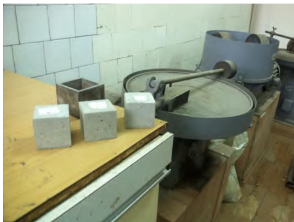
Рис. 9. Круг истирания ЛКИ-2 и образцы для испытания.
