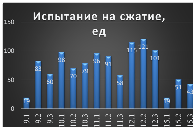
Рис. 5. График зависимости прочности ЦДП от процентного содержания жидкого стекла (15%).
