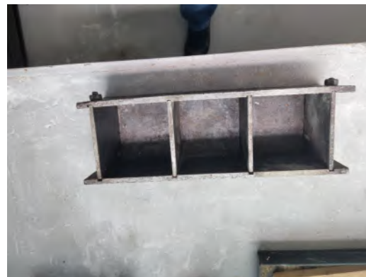
Рис.3. Форма для изготовления бетонных кубиков
