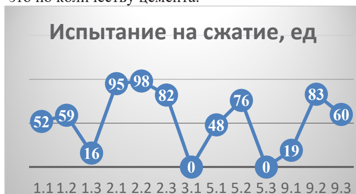
Рис. 7. График зависимости прочности на сжатие от количества цемента в составе 80%.
