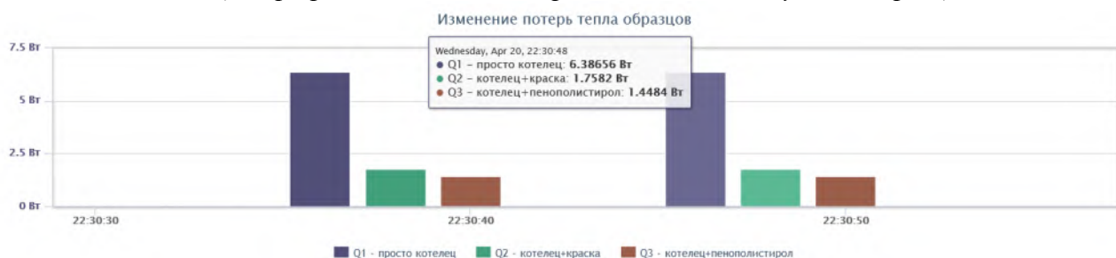
Рис. 11. Общий график изменений потерь тепла на испытуемых образцах.
