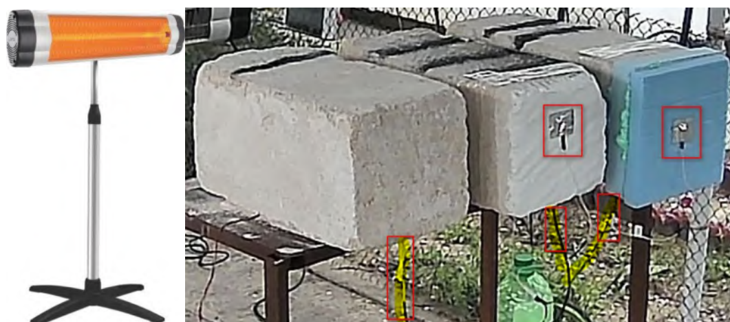
Рис. 92. УФО обогреватель и образцы с подключенными датчиками измерения температур.
